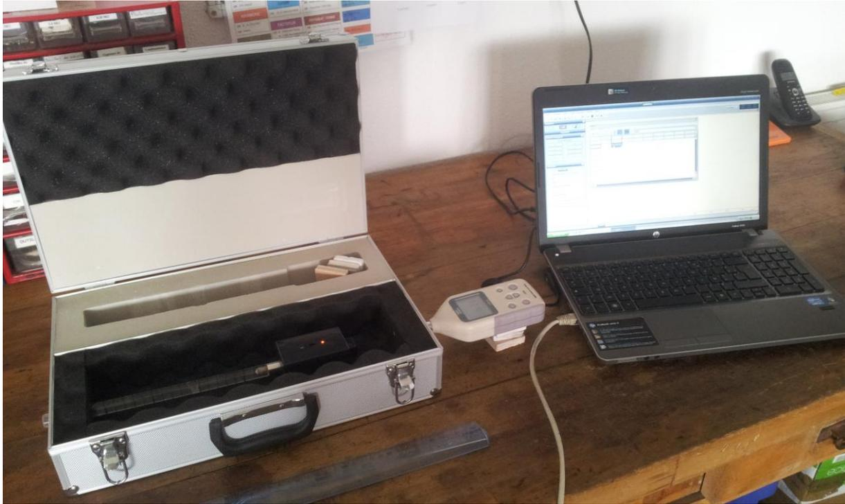
1. On peut alors relever le niveau sonore en fonction de la distance source/sonomètre et compléter le tableau suivant :
